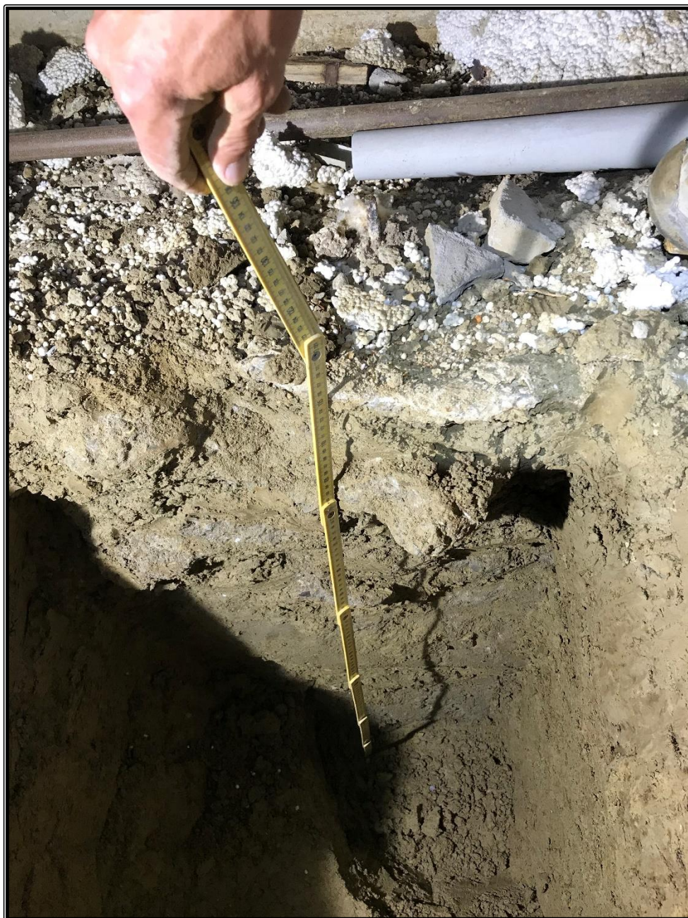
Figura 17 - saggio n° 6; spessore magrone riscontrato: 115cm
