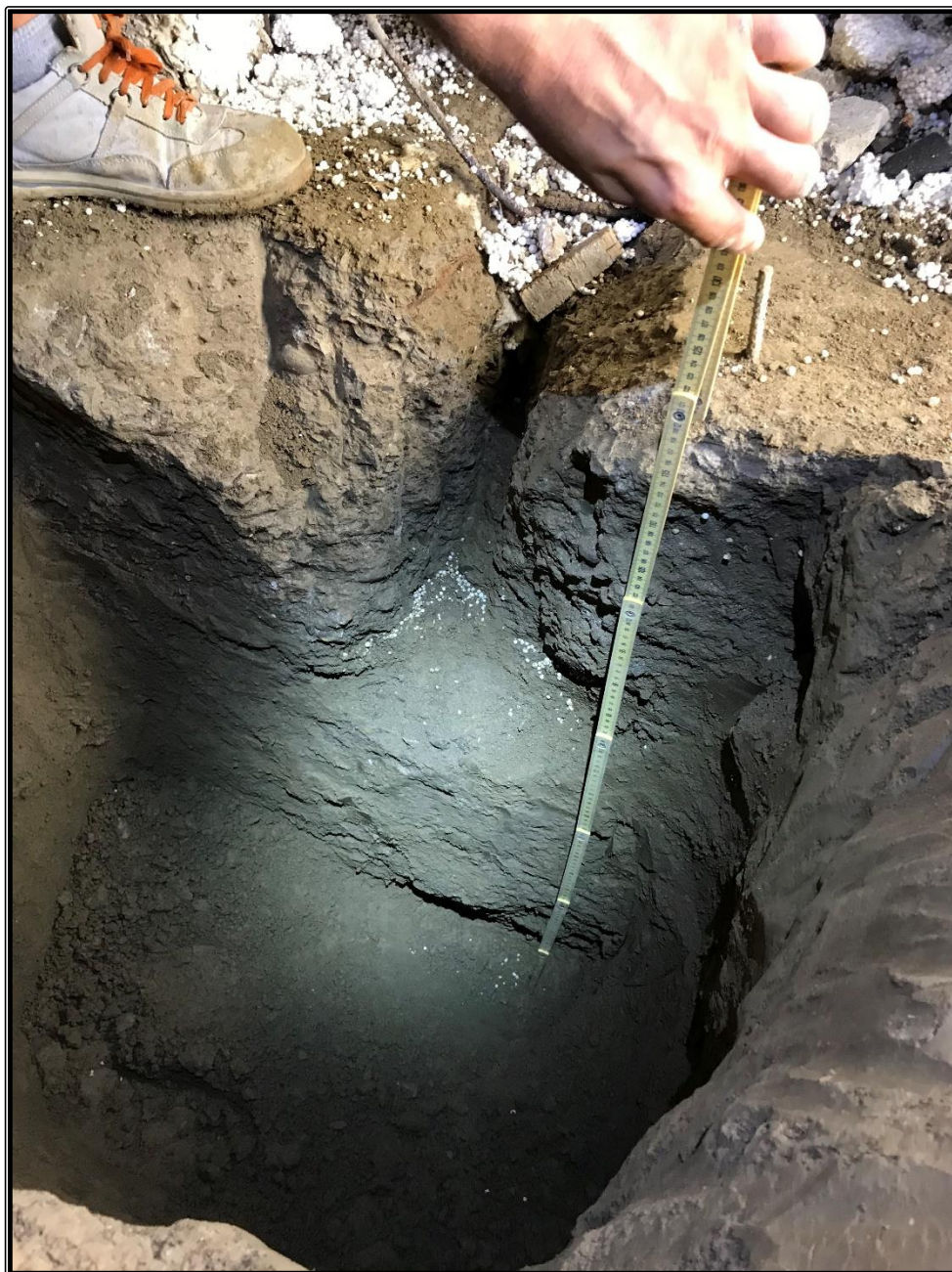
Figura 12 - saggio n° 1; spessore magrone riscontrato: 115-120cm
