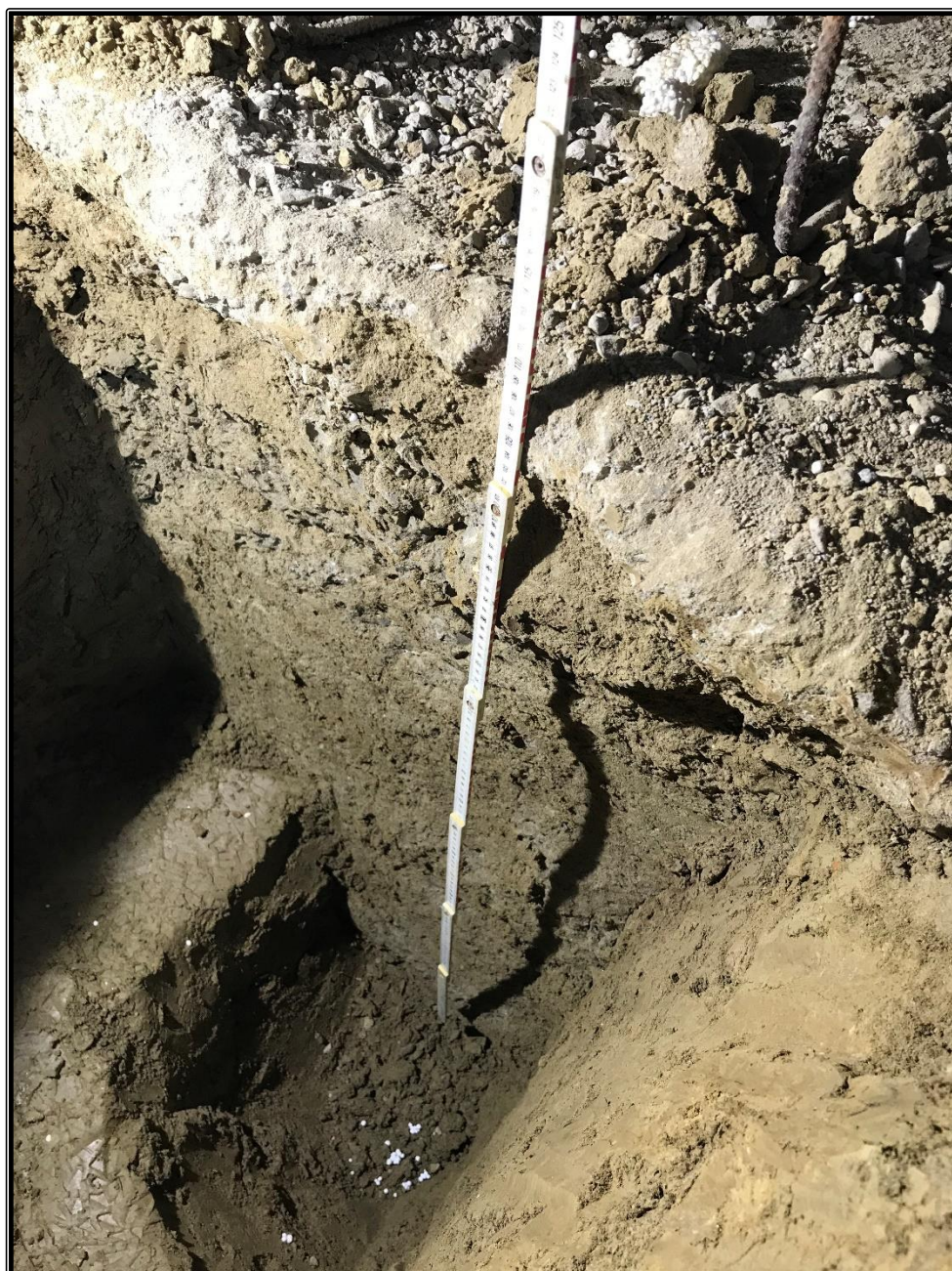
Figura 15 - saggio n° 4; spessore magrone riscontrato: 110cm
