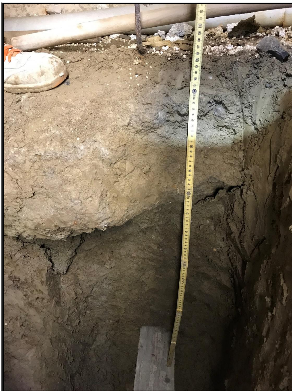
Figura 16 - saggio n° 5; spessore magrone riscontrato: 105cm
