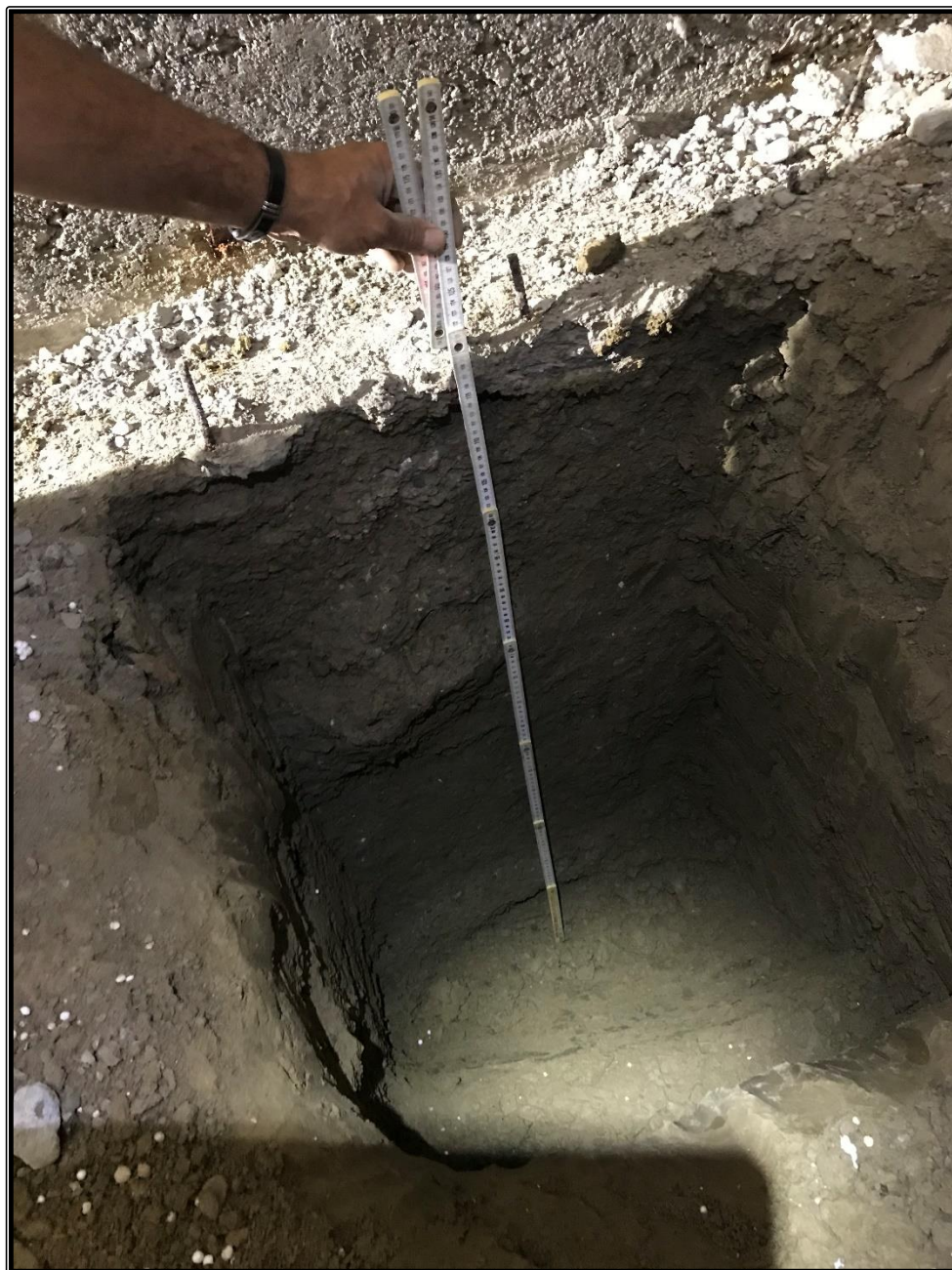
Figura 14 - saggio n° 3; spessore magrone riscontrato: 120cm
